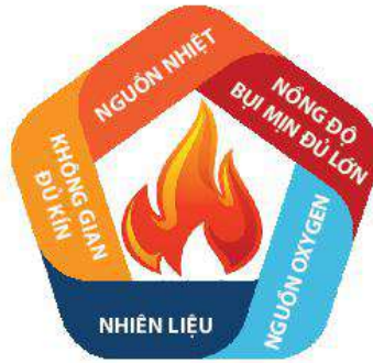
▲ Hình 5.8. Ngũ giác nổ bụi (dust explosion pentagon)
