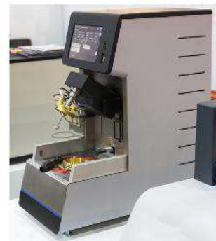
▲ Hình 6.1. Thiết bị xác định điểm chớp cháy: cốc hồ Cleveland tự động
