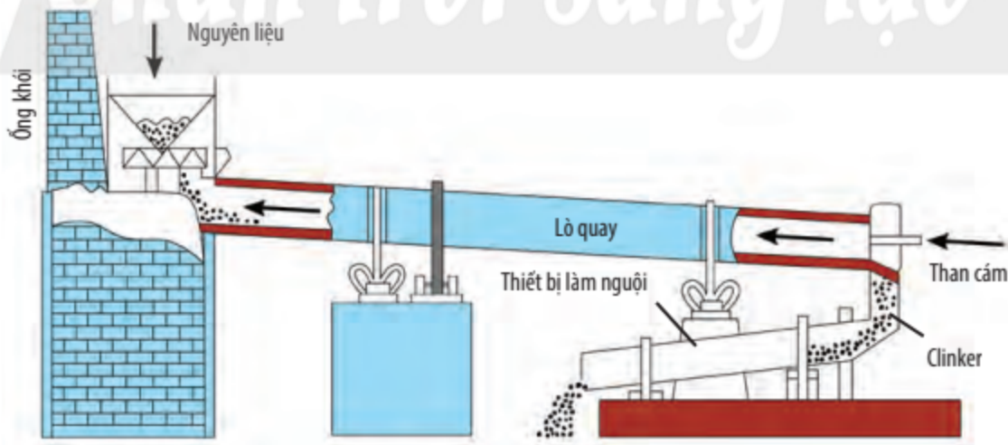
▲ Hình 4.8. Sơ đồ lò quay sản xuất clinker
