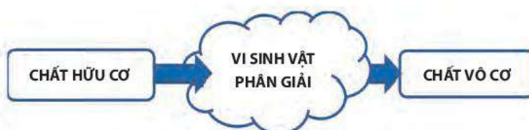
Hình 11.1. Sơ đồ quá trình phân giải các chất hữu cơ của vi sinh vật
