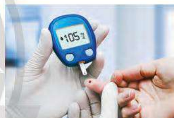
Hình 6.3. Máy xác định hàm lượng glucose trong máu sử dụng điện cực enzyme glucose oxidase
