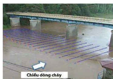
▲ Hình 3.3. Hệ thống KU_STIV đo dòng chảy của sông (Nguồn: MDPI)
