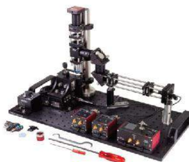
▲ Hình 2.9. Nhíp quang học (optical tweezer) dùng tia laser có độ hội tụ cao để bẫy và dịch chuyển các hạt có kích thước từ micrômét đến nanômét
