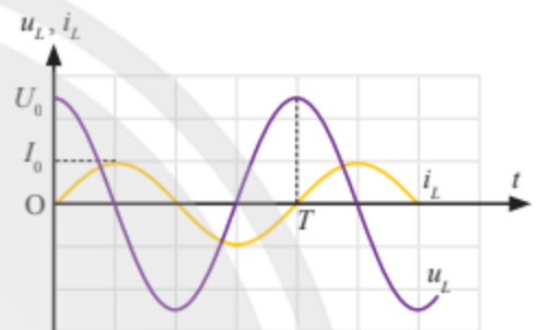
▲ Hình 1.11. Sự biến thiên của u và i theo thời gian trong đoạn mạch chỉ có cuộn cảm thuần
