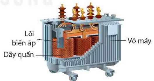
Hình 3.2. Mô tả một số bộ phận của máy biến áp
