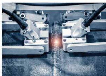
Hình 7.8. Ứng dụng siêu âm để hàn vật liệu
