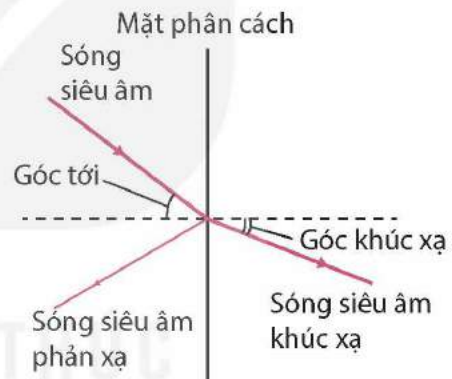
Hình 7.3. Một sóng siêu âm khi chạm vào ranh giới giữa hai vật liệu khác nhau, vừa bị khúc xạ vừa bị phản xạ
