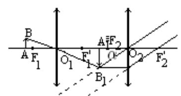
$$\text{*Khi ngắm chừng ở vô cực: } \alpha \approx tg\alpha = \frac{A_1B_1}{f_2} = \frac{k_1 \cdot AB}{f_2} \rightarrow AB_{min} = \frac{f_2}{k_1} \cdot \alpha_{min}$$
