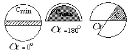
**CHỦ ĐỀ 7.**Mạch  $LC$  ở lối vào của máy thu vô tuyến có tụ xoay biến thiên  $C_{max} \div C_{min}$ : tìm dải bước sóng hay dải tần số mà máy thu được?
