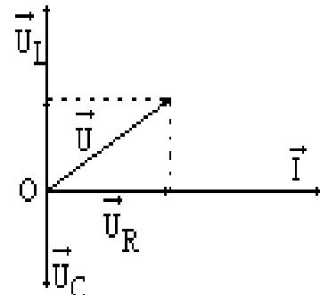
$$\text{Độ lệch pha: } \operatorname{tg}\varphi = \frac{Z_L - Z_C}{R} = \frac{IZ_L - IZ_C}{IR} \quad \text{Hay } \operatorname{tg}\varphi = \frac{U_L - U_C}{U_R}$$
