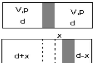
Ta được phương trình:  $x'' + \omega^2 x = 0$ , nghiệm của phương trình có dạng:  $x = A \sin(\omega t + \varphi)$ , vậy hệ dao động điều hoà. Chu kỳ:  $T = \frac{2\pi}{\omega}, \text{ với } \omega = \sqrt{\frac{md^2}{2p_0 V_0}}$
