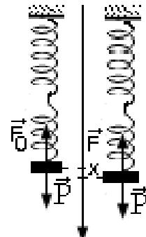
$$\text{Hệ lò xo giãn đoạn } x: F = -k_{\text{hệ}} x \rightarrow x = -\frac{F}{k_{\text{hệ}}}$$
