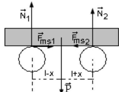
Ta được phương trình:  $x'' + \omega^2 x = 0$ , nghiệm của phương trình có dạng:  $x = A \sin(\omega t + \varphi)$ , vậy hệ dao động điều hoà.
