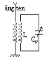
**CHỦ ĐỀ 6.** Mạch LC ở lối vào của máy thu vô tuyến có tụ điện có điện dung biến thiên  $C_{max} \div C_{min}$  tương ứng góc xoay biến thiên  $0^\circ \div 180^\circ$ : xác định góc xoay  $\Delta\alpha$  để thu được bức xạ có bước sóng  $\lambda$ ?
