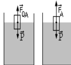
Ta được phương trình:  $x'' + \omega^2 x = 0$ , nghiệm của phương trình có dạng:  $x = Asin(\omega t + \varphi)$ , vậy hệ dao động điều hòa.
