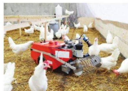
Hình 20.6. Robot dọn vệ sinh và thu trứng trong trại gà đẻ
