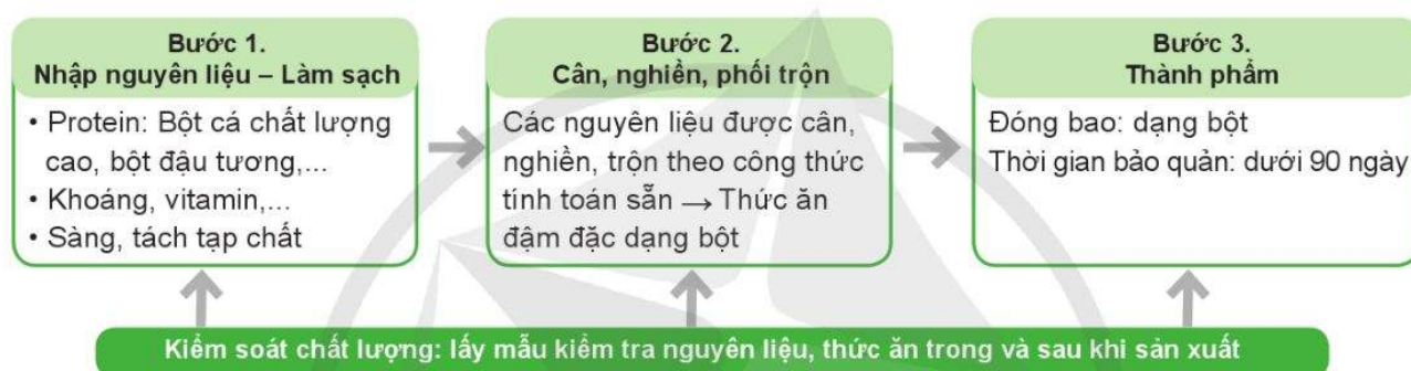
Hình 10.5. Quy trình sản xuất thức ăn đậm đặc ở quy mô công nghiệp
