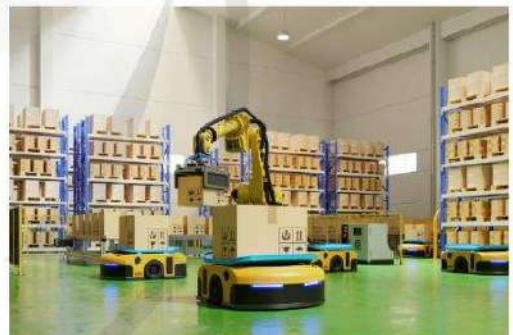
Hình 12.2. Robot công nghiệp vận chuyển nguyên vật liệu và sản phẩm
