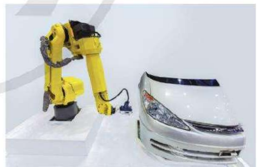
Hình 12.14. Robot kiểm tra hình dạng và kích thước một số bộ phận của ô tô
