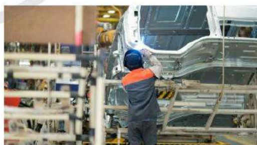
Hình 16.2. Hàn khung xe ô tô
