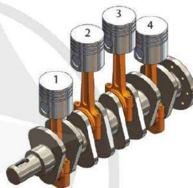
Hình 18.7. Bố trí cơ cấu trục khuỷu thanh truyền động cơ 4 xilanh
