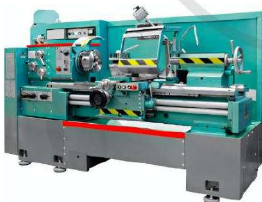
Hình 8.2. Máy tiện vạn năng
