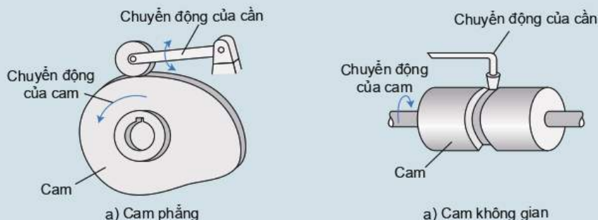
Hình 12.4. Một số nguyên lý cơ cấu cam
