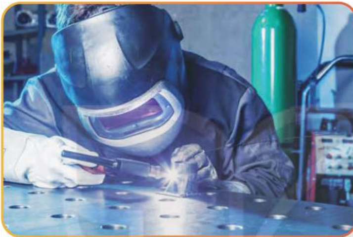
Hình 14.1. Công đoạn hàn kim loại
