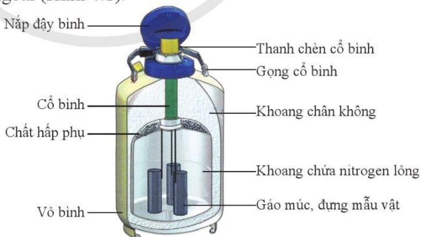
Hình 4.1. Cấu tạo của bình bảo quản mẫu vật bằng nitrogen lỏng
