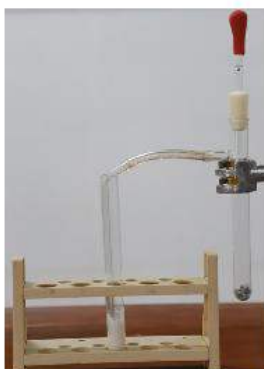
▲ Hình 13.7. Acetylene tạo kết tủa vàng nhạt với dung dịch \text{AgNO}_3 trong ammonia
