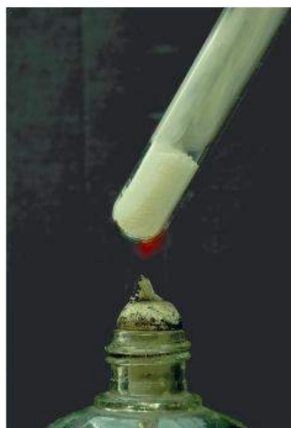
▲ Hình 4.6. Sự phân huỷ nhiệt của \text{NH}_4\text{Cl}
