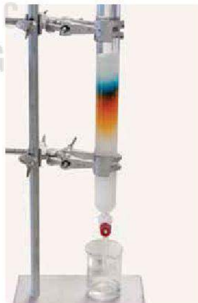
Hình 11.8. Thiết bị, dụng cụ thực hiện tách chất bằng phương pháp sắc kí cột
