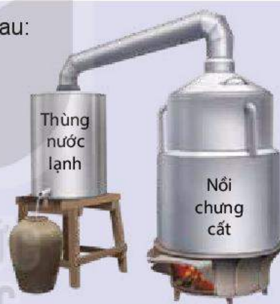
Hình 11.1. Thiết bị nấu rượu thủ công
