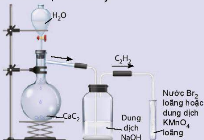
Hình 16.6. Điều chế acetylene và thử tính chất
