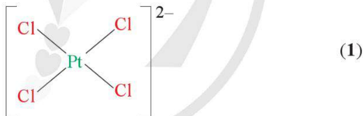
Hình 21.1. Cấu tạo của phức chất [PtCl_4]^{2-}
