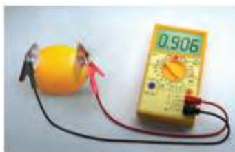
▲ Hình 12.6. Sơ đồ pin chanh
