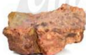
Quặng bauxite (Thành phần chính: Al_2O_3 )
