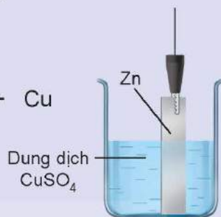
Hình 15.6. Nhúng thanh Zn vào dung dịch \text{CuSO}_4
