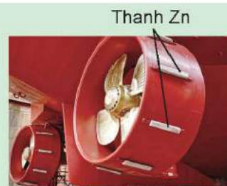
Hình 22.4. Bảo vệ thép bằng phương pháp điện hoá
