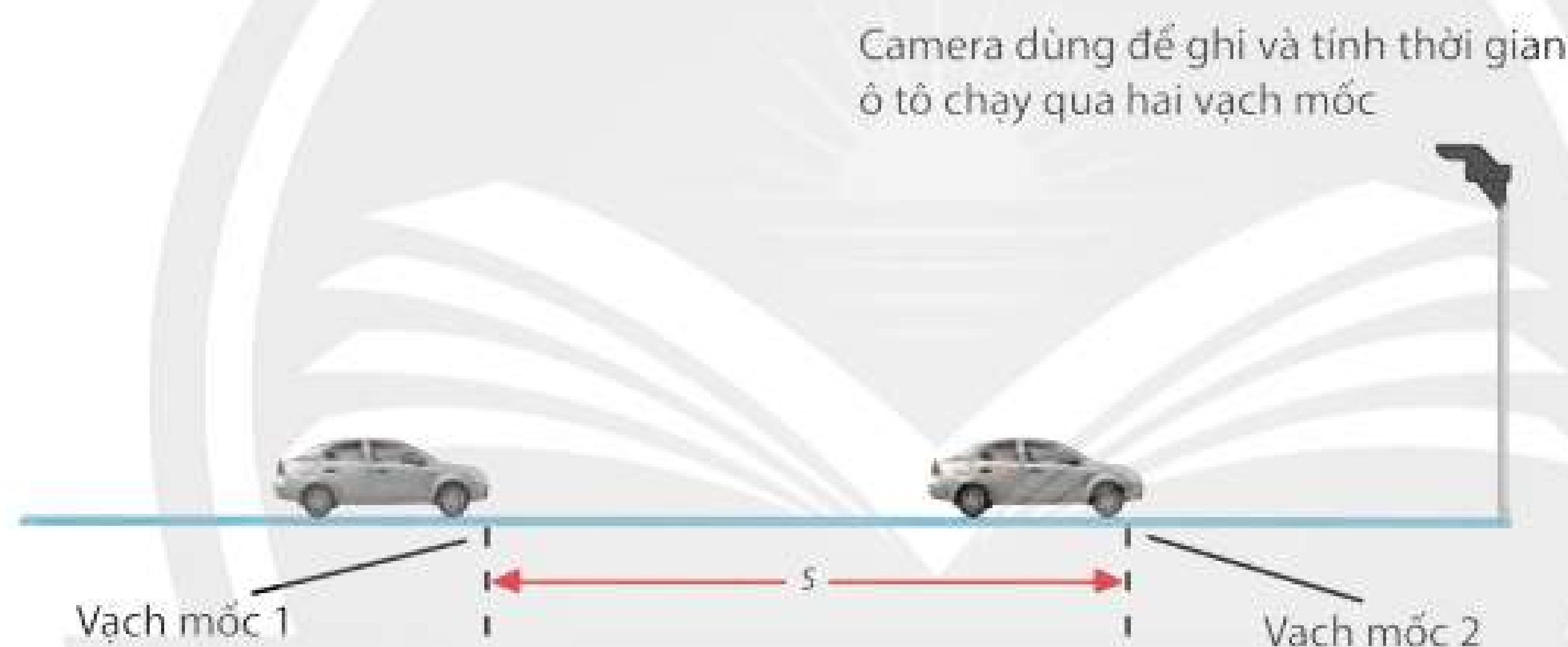
▲ Hình 11.1. Cách đo tốc độ bằng thiết bị “bắn tốc độ” gắn cố định
