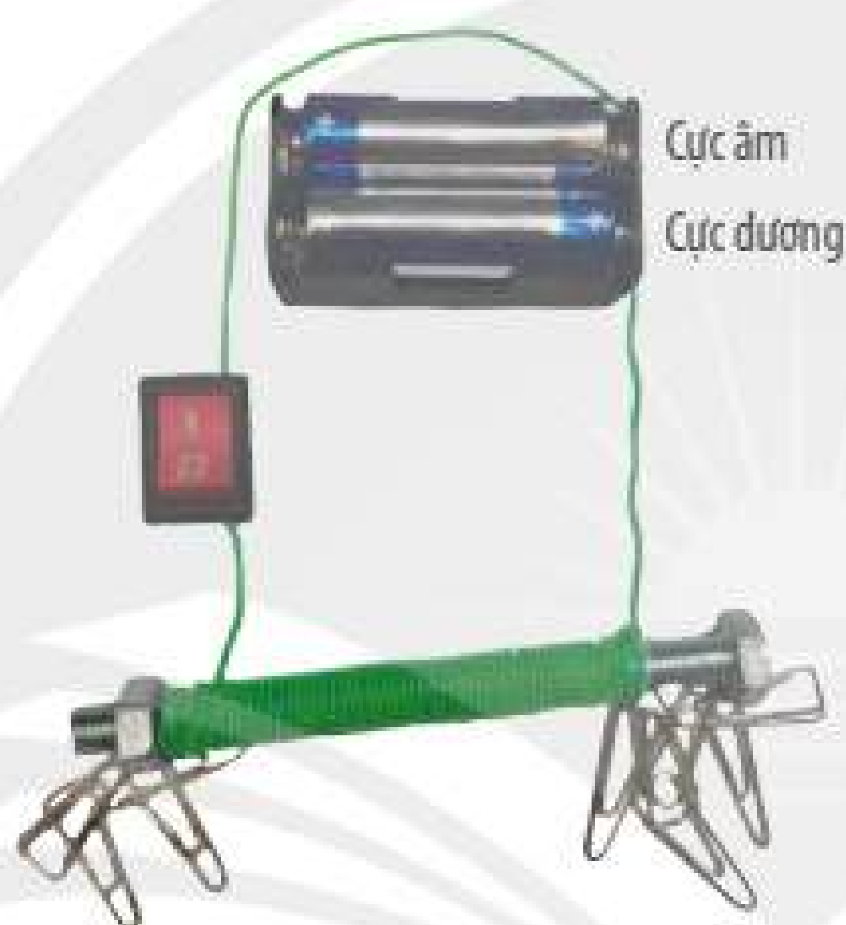
▲ Hình 21.2. Thí nghiệm tạo nam châm điện với hai pin 1,5 V
