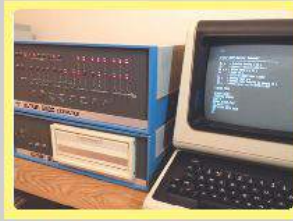
Hình 4. Máy tính An-te 8800 – máy tính cá nhân đầu tiên (do Pôn A-len và Bin Gét viết phần mềm, 1975)
