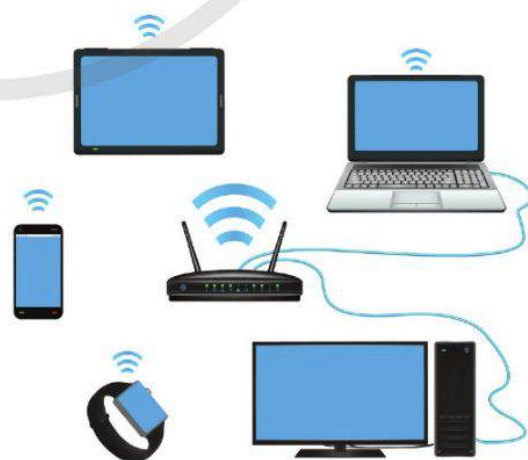
Hình 6. Access Point sử dụng sóng vô tuyến để truyền tải dữ liệu giữa các thiết bị trong mạng không dây
