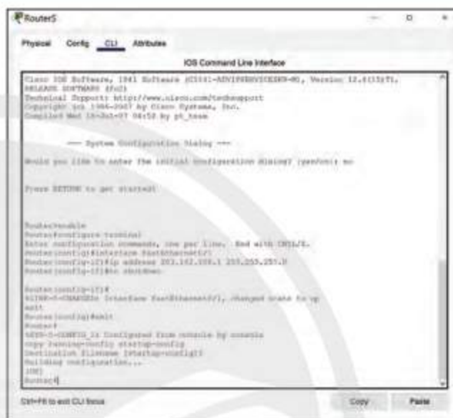
Hình 10. Cấu hình kết nối Internet cho Router 1841
