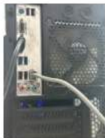
Hình 6a. Kết nối cáp mạng với máy tính
