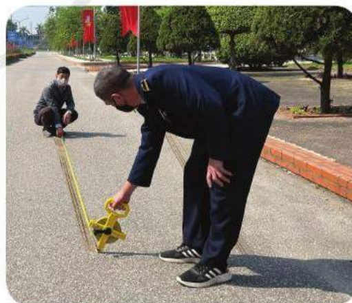
Hình 2.1. Thanh tra giao thông đo vết phanh xe trong kiểm tra tốc độ xe khi phanh
