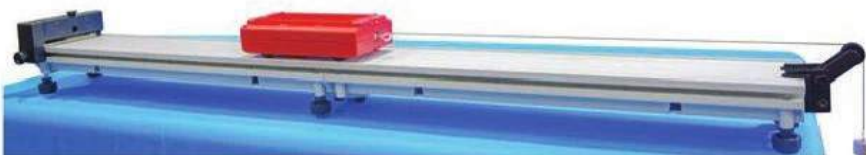
Hình 1.2. Thí nghiệm khảo sát liên hệ giữa lực và gia tốc
