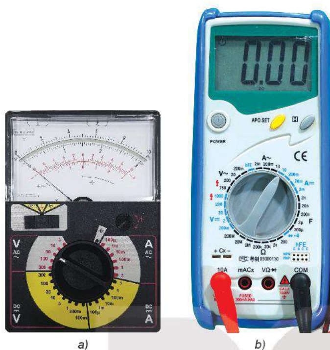
Hình 2.6. Đồng hồ đo điện đa năng kim khung quay a) và đồng hồ đo điện đa năng hiện số b)
