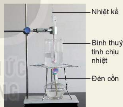
Hình 2.2. Thí nghiệm đo nhiệt độ sôi của nước
