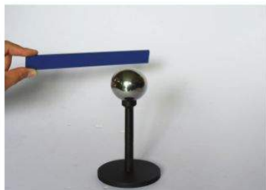
Hình 1.4. Thí nghiệm với thanh nhựa và quả cầu kim loại.
