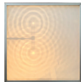
▲ Hình 8.3. Hình ảnh giao thoa sóng nước thu được trên màn
