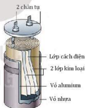
Hình 21.5. Cấu tạo của tụ điện hình trụ
