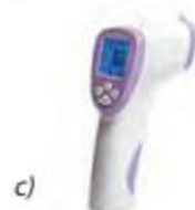
▲ Hình 2.2. a) Nhiệt kế thủy ngân; b) Nhiệt kế điện trở; c) Nhiệt kế hồng ngoại điện tử
