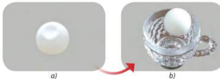
▲ Hình 3.3. a) Quả bóng bàn bị móp; b) Quả bóng bàn phồng trở lại khi đặt vào cốc nước nóng
