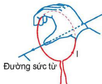
Hình 14.10. Quy tắc nắm bàn tay phải đối với dòng điện tròn
