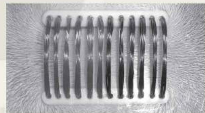
Hình 14.6. Hình ảnh các mạt sắt phân bố bên trong và bên ngoài ống dây mang dòng điện
