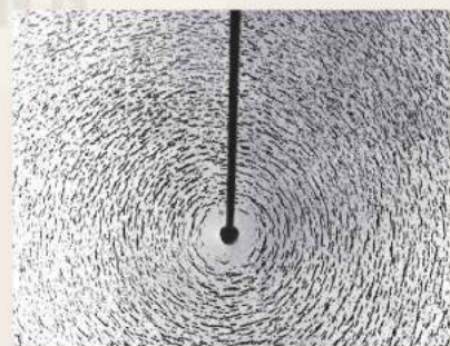
Hình 14.7. Hình ảnh các mạt sắt phân bố xung quanh dòng điện thẳng
