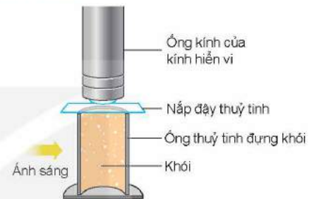
Hình 8.1. Sơ đồ thí nghiệm quan sát chuyển động Brown trong không khí
